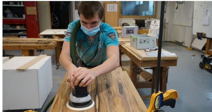
Ponçage des plateaux en palissandre et préparation pour recevoir le produit de finition
